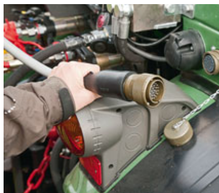
Die Fernbedienung ist per Kabel über eine so genannte Cannon-Steckdose im Schlepperheck verbunden. Diese sowie einen kompletten zweiten Kabelbaum rüstet Armin Kremler für den Vario Assistant nach.
