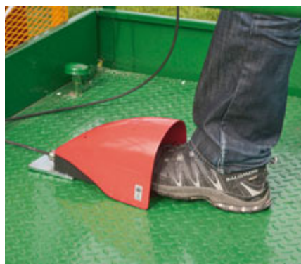
Der fernbediente Schlepper fährt nur, wenn der Fußschalter durchgetreten ist.
