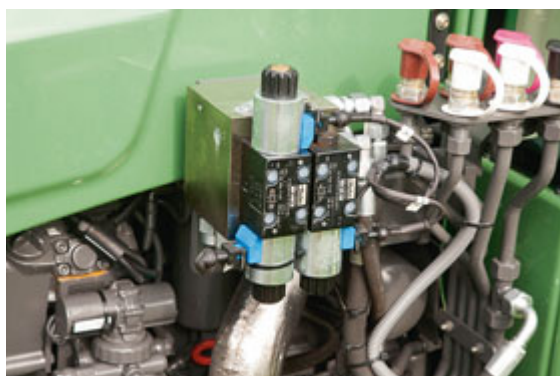
Für die Fernbedienung der Lenkung wird ein zusätzlicher Lenkventilblock eingebaut.
