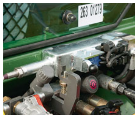
Die Lebensversicherung: Ein zusätzlicher Zylinder schließt die Federspeicherbremse in Notfällen.
