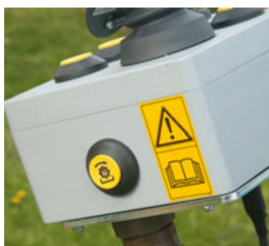
Auch die Zapfwelle kann per Fernbedienung ein- und ausgeschaltet werden. Das ist nützlich z. B. für den Betrieb einer pneumatischen Baumschere.
